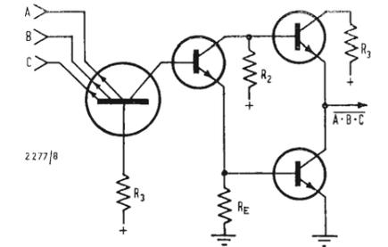
Fig. 5 - Porta « Nand » secondo la tecnica H.L.T.T.L.
