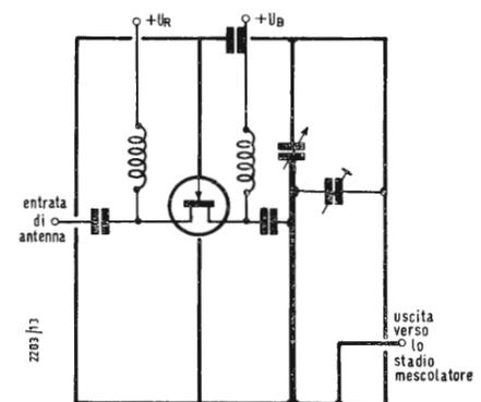
Fig. 7 - Stadio preamplificatore UHF con C.A.G. applicato alla sorgente. La porta può essere collegata a massa, però per la regolazione occorre dissipazione di potenza.
