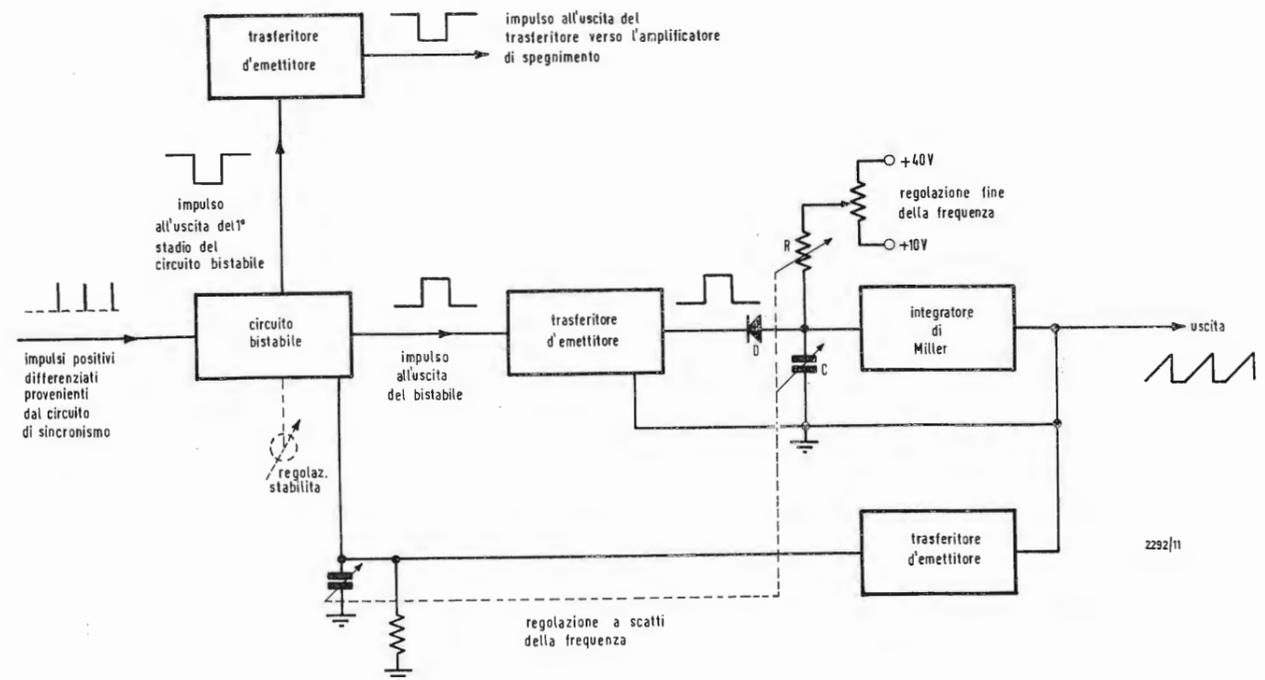
Fig. 6 - Schema a blocchi del circuito generatore dell'asse-tempi.
