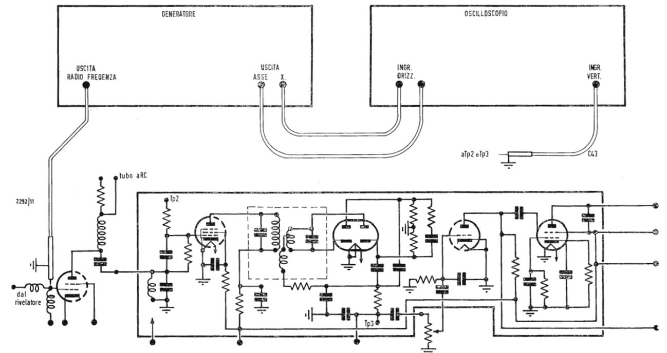
Fig. 9 - Collegamenti da effettuarsi per l'allineamento dei circuiti suono e del discriminatore
