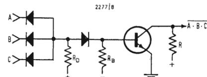
Fig. 3 - Porta « Nand » secondo la tecnica D.T.L.; per la porta « Nand » o « Inhibit » il segnale di uscita sarà  $L$  nel caso in cui un ingresso sia  $O$ , ed il segnale di uscita  $O$  se nessun ingresso è  $O$ .
