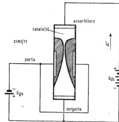
Fig. 1 - Struttura fondamentale di un transistoro a effetto di campo.
