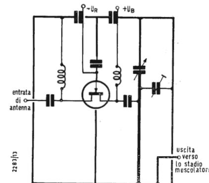
Fig. 6 - Schema dello stadio preamplificatore UHF. La tensione di polarizzazione controlla senza dissipazione di potenza, la porta del transistore a effetto di campo.
