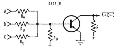
Fig. 2 - Porta « Nor » secondo la tecnica R.T.L.
