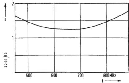
Fig. 3 - Fattore  $K$  di stabilità del transistore a effetto di campo tipo SF4789 in funzione della frequenza.
