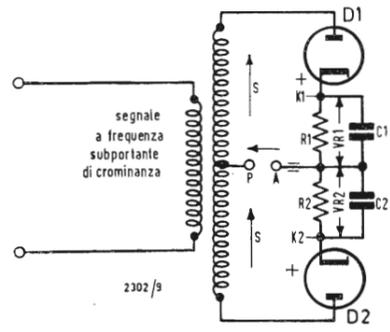
Fig. 3 - Rivelatore sincrono a due diodi
