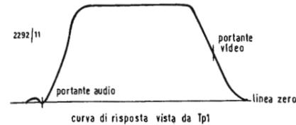
Fig. 8 - Curva tipica di risposta d'un amplificatore FI-TV.
