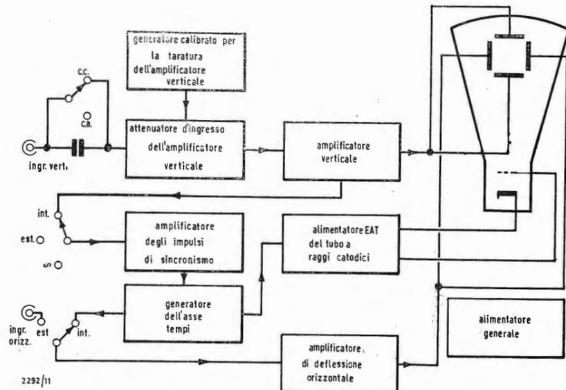
Fig. 2 - Schema a blocchi dell'oscilloscopio G 401.
