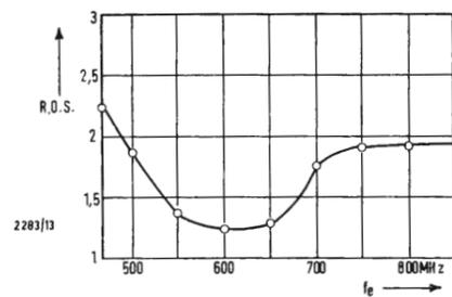
Fig. 9 - Rapporto di onde stazionarie del preamplificatore FET ai capi dell'impedenza diventata 50 Ω. I valori rimangono minori di 2,2 nell'intera gamma, poiché l'impedenza di entrata non si scosta sensibilmente dal valore nominale.
