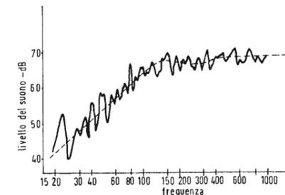
Fig. 1 - Curva di risposta di un altoparlante in una stanza (linea unita). La linea tratteggiata indica la curva di risposta dello stesso altoparlante in aria libera.
