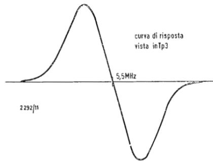
Fig. 11 - Curva tipica di risposta al punto Tp3 del circuito di fig. 9.
