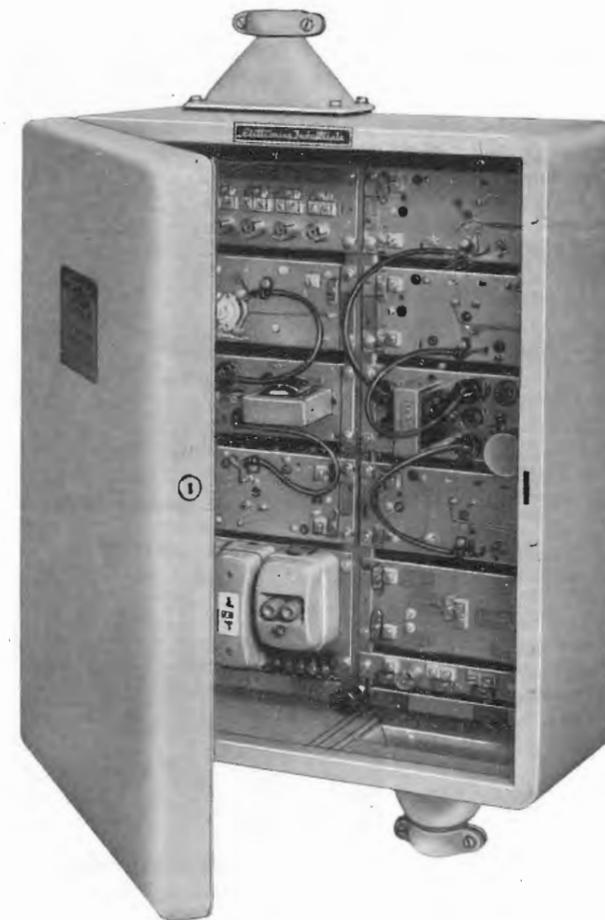
Fig. 1 - Centralino completamente transistorizzato per più di 60 utenti. 1° progr. + 2° progr. + FM + Svizzera (costruzione Elettronica Industriale).
