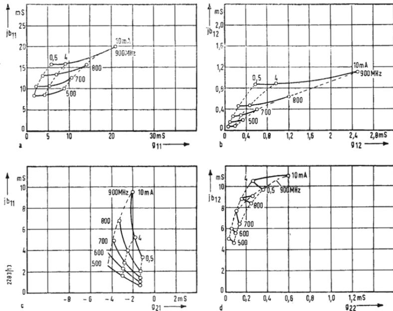
Fig. 2 - Rappresentazione dei parametri  $y$  del transistore a effetto di campo tipo SF7489 in circuito con porta in comune; a)  $y_{11g}$ ; b)  $y_{12g}$ ; c)  $y_{21g}$ ; d)  $y_{22g}$ ;  $U_{ds} = 15$  V;  $I_d = 0,5 \div 10$  mA.
