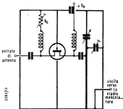
Fig. 4 - Il transistore a effetto di campo semplifica sostanzialmente il preamplificatore UHF.
