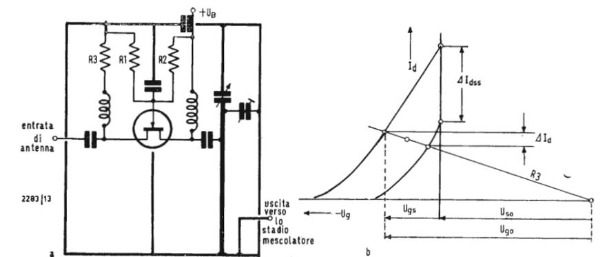
Fig. 5 - Il divisore di tensione  $R_1/R_2$  provvede al mantenimento del punto di lavoro e limita le dissipazioni del campione in esame. a) schema dell'ingresso; b) rappresentazione delle relazioni elettriche.
