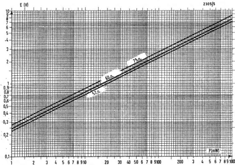
Fig. 4 - Diagramma potenza in funzione delle tensioni applicate ad un resistore puro.
