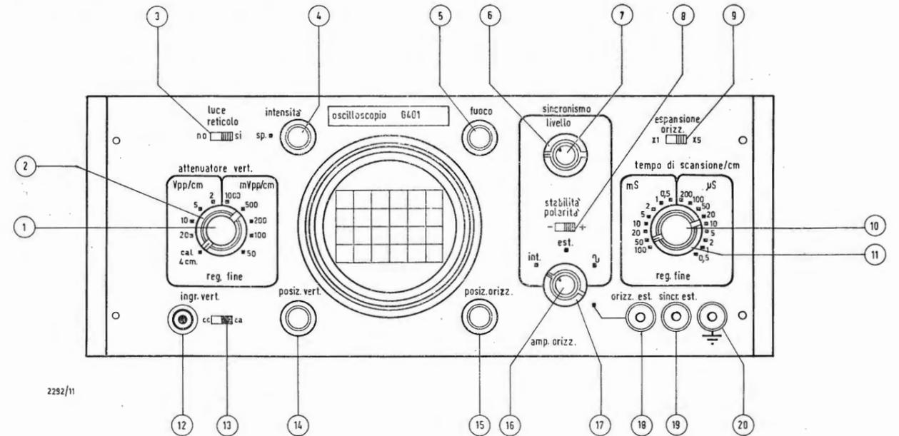
Fig. 3 - Comandi ed ingressi dello strumento.
