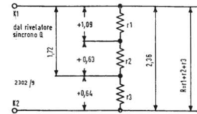
Fig. 5 - Circuito matrice di Q.
