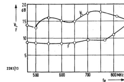
Fig. 12 - Amplificazione di potenza e figura di rumore in funzione della frequenza per il sintonizzatore UHF con stadio preamplificatore FET.
