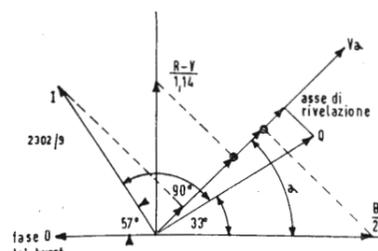
Fig. 2 - Costruzione del segnale di uscita di un rivelatore sincrono operante su un particolare asse di rivelazione.
