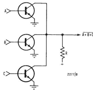
Fig. 1 - Porta « Nor » secondo la tecnica D.C.T.L.; la porta « Nor » è una porta « Or » invertita. Il suo segnale di uscita sarà  $L$  se tutti gli ingressi sono  $O$ , e la sua uscita  $O$  se uno o più ingressi sono  $L$ .
