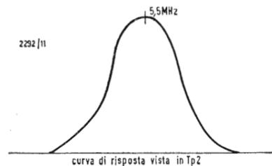
Fig. 10 - Curva tipica di risposta al punto Tp2 del circuito di fig. 9.
