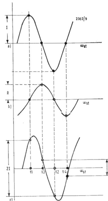
Fig. 1 - Principio della rivelazione sincrona. a) componente I della subportante; b) componente Q della subportante; c) segnale subportante totale, somma a) + b).
